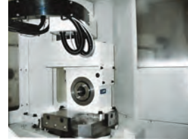
Sahada adapte edilebilir 5. Eksen Döner Tabla (Her iki palet için de uygulanabilir)
